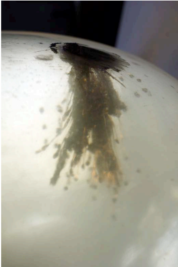
Photos n° 13 et 14 : Modèle après impact (vues rapprochées)
